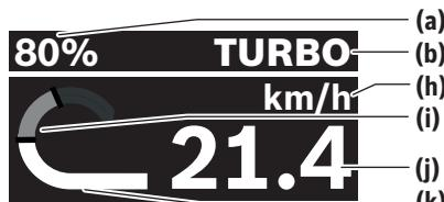
(a) Livello di carica della batteria della eBike (configurabile)
